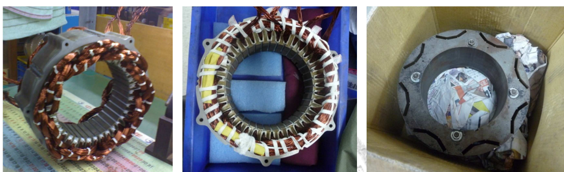
(a)定子+繞線（整線前） (b)定子+繞線（整線後） (c)轉子（無磁鐵）
