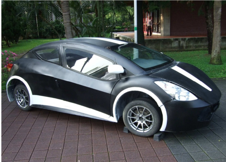
圖 1-5 本研究團隊自行開發製造的都會型鋰電池電動車 Green Jumper
