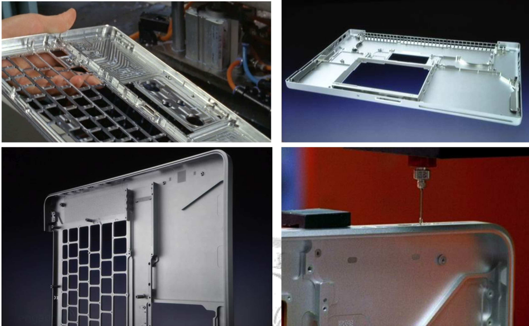
圖 5-4 採用 CNC 量產加工的筆記型電腦外殼
