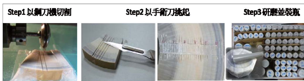
Fig. 3-14 碳氧同位素材料製備流程
