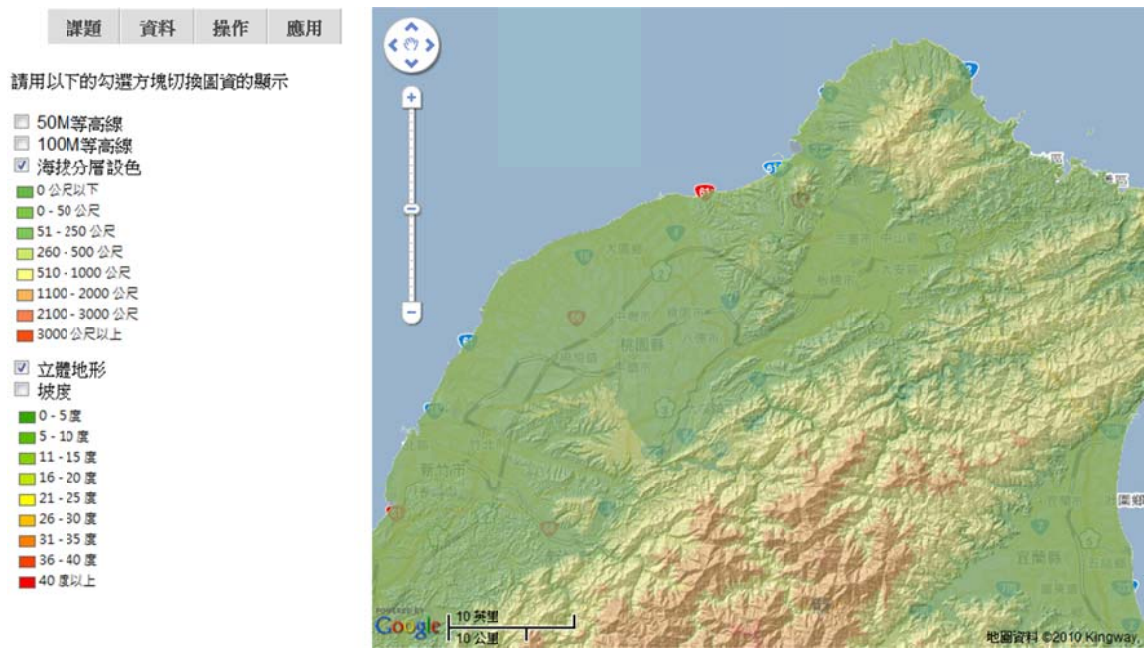
圖 4.11 開啟 DEM 海拔分層設色與黑白暈渲圖層，呈現的是彩色立體地形效果
