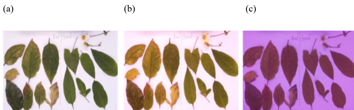
圖 3-14 不同光源下的葉片圖像 (a)原始 RGB 圖像 (b) RGB+UV-A，即 UV-A 光源開啟下的 RGB 圖像 (c) IR+B，即藍/NIR 濾光片下的紅外圖像。
