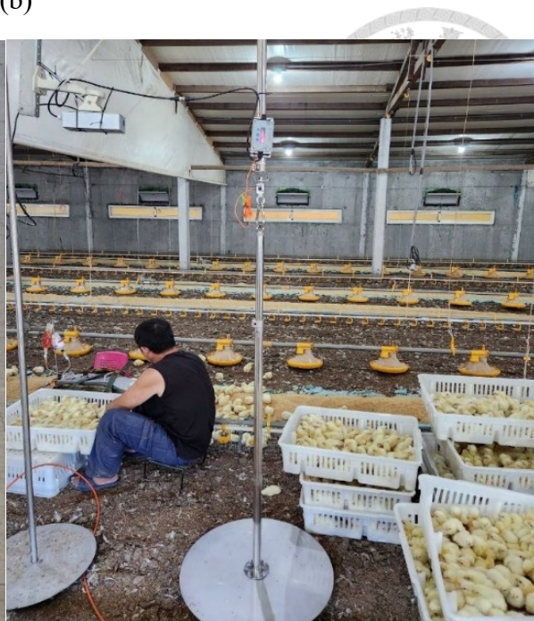
圖 3-24 AI 自動物理磅秤 (a) 雙目鏡頭 IoT 整合磅秤 (b) 裝設商業化肉雞養殖場。
