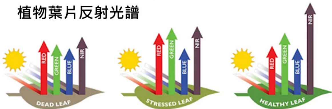
圖 2-1 (a) NDVI 表示植物葉片健康狀態；(b)健康的葉子會吸收 RED 光並反射 NIR 光。
