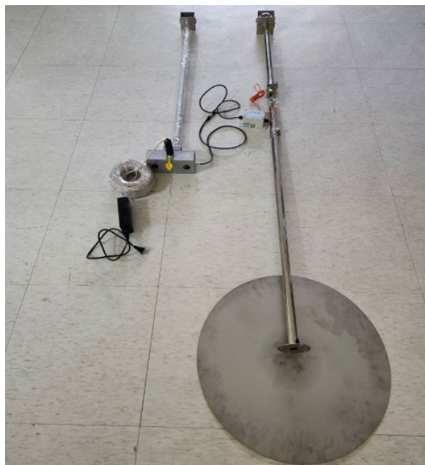
圖 3-24 AI 自動物理磅秤 (a) 雙目鏡頭 IoT 整合磅秤 (b) 裝設商業化肉雞養殖場。
