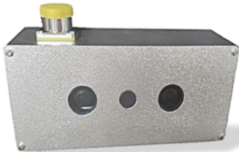
圖 3-21 雙目立體視覺系統與 POE 供電系統。
