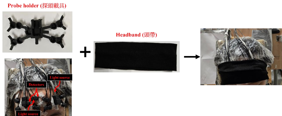
圖 2.7 探頭載具結構及貼附於頭皮表面的方式
