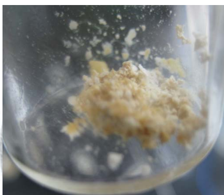
照片 4.3.2-2 NTU-1 細菌結塊加入去離子水冷凍後，真空乾燥 2 天後所呈現的溼黏狀態（冷凍乾燥失敗）。
