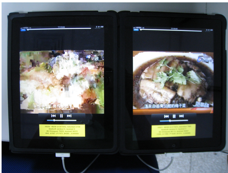
Figure 5.1: 實驗一：右邊為使用QoS機制，左邊則否。右邊得到較佳的觀賞品質。料塊數量的門檻，如果需求量超過這個門檻，就會將超過的部分傳給另一個裝置，請它去下載。我們設定的門檻值為50個資料塊。
