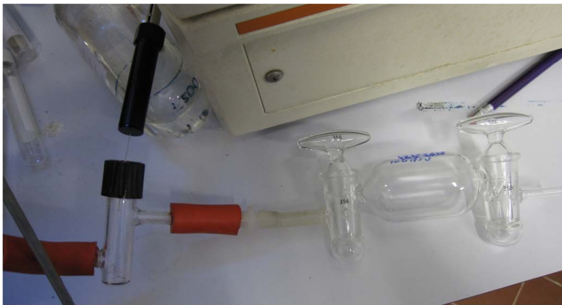
圖 2-4：來自台灣的標本正在進行固相微萃取。
