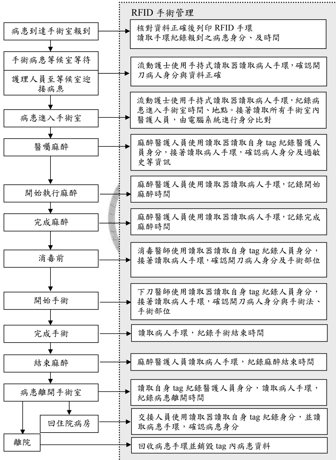
圖 2-3.2 RFID 手術室作業流程
