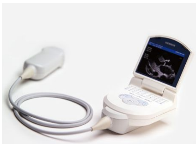
圖5-7 Siemens 口袋超音波：Acuson P10
