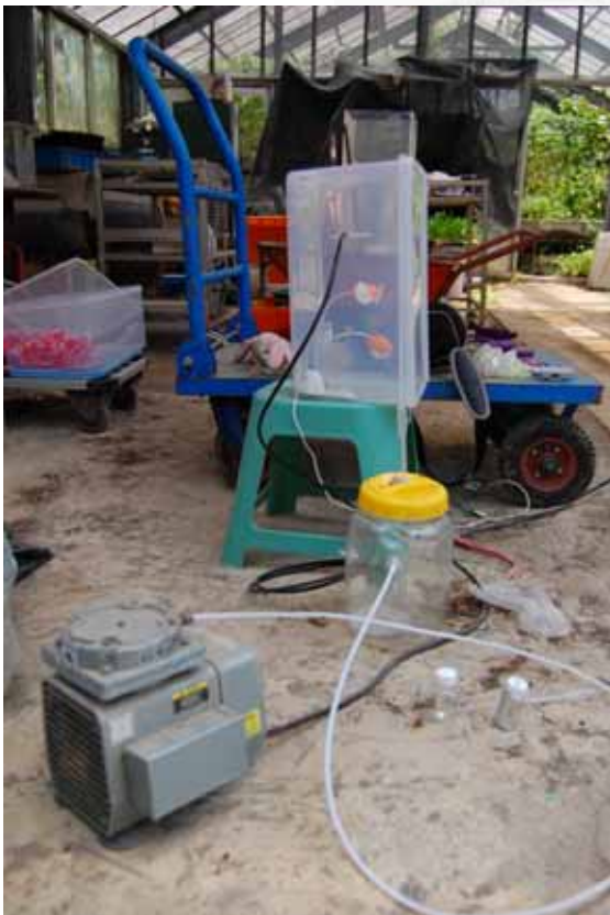
圖十三、熏氣箱及氣體揮發產氣裝置，內有幫浦連接產氣瓶及熏氣箱
