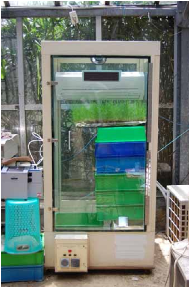
圖十四、本研究所用之煙霧反應室(Smog chamber)
