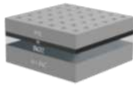
Fig. 3.25 電子束微影及顯影示意圖
