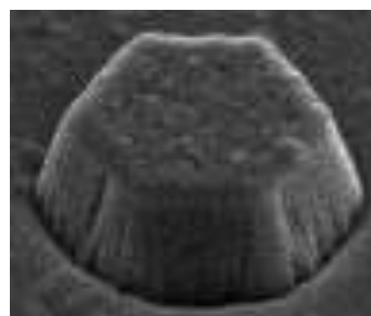
Fig. 5.25 單一奈米柱之 SEM 圖(週期 5000nm、編號 E)
