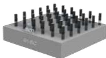
Fig. 3.28 RIE 蝕刻二氧化矽薄膜示意圖
