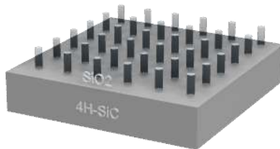
Fig. 5.19 圖案化二氧化矽柱示意圖
