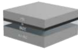
Fig. 3.24 光阻塗佈示意圖
