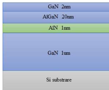
Fig. 5.1 Sample A 磊晶結構示意圖
