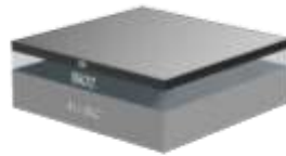
Fig. 3.23 鍍 3nm 鉻金屬薄膜示意圖
