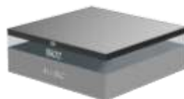
Fig. 3.11 鍍 3nm 鉻金屬薄膜示意圖
