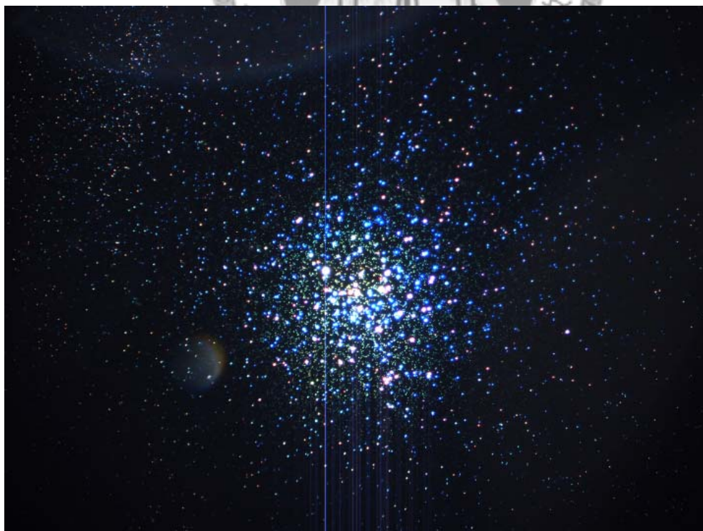
圖 41：40 nm 金奈米粒子與 40 nm 銀奈米混合之 CCD 影像。
