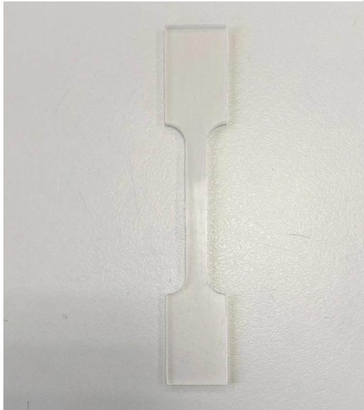
圖 3-4 矽橡膠之單軸拉伸試片
