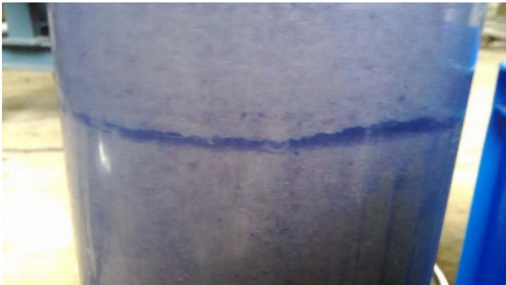
圖 3.11 砂柱試體之劈裂現象
