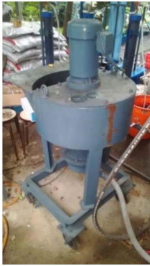
A. 高速渦輪攪拌機
