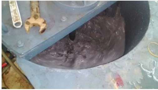
A. 基質高速拌合情形
