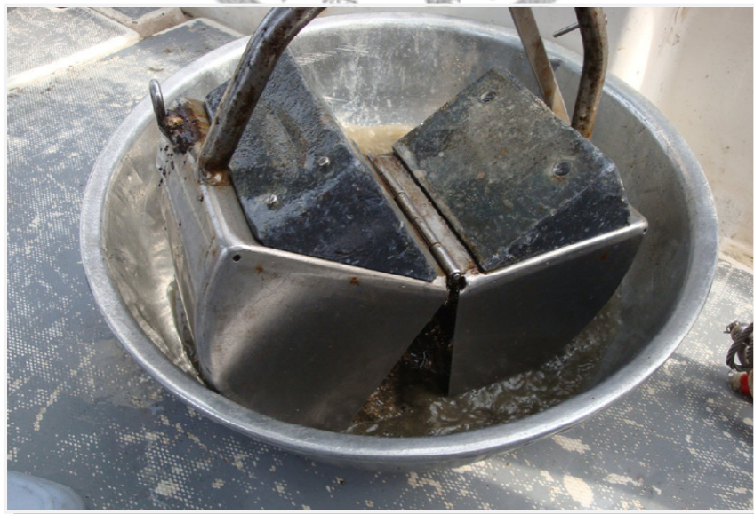
圖 2-22 進行底質沉積物採樣使用的抓斗式採泥器。
