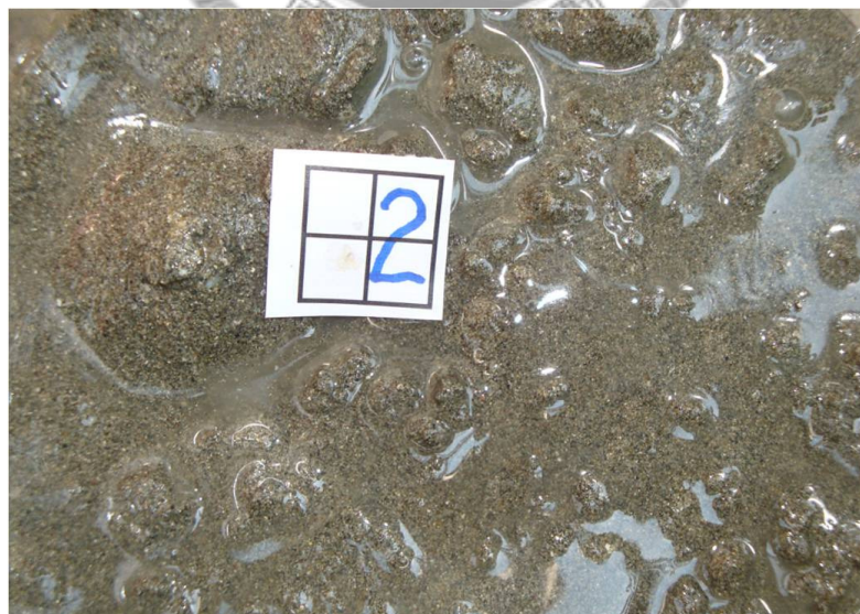
圖3-7 在風櫃近岸區水深20公尺處採集到的表層沉積物，照片中田字形方格長寬各2公分，上面的編號為採樣點編號。此沉積物樣本為細砂顆粒大小。
