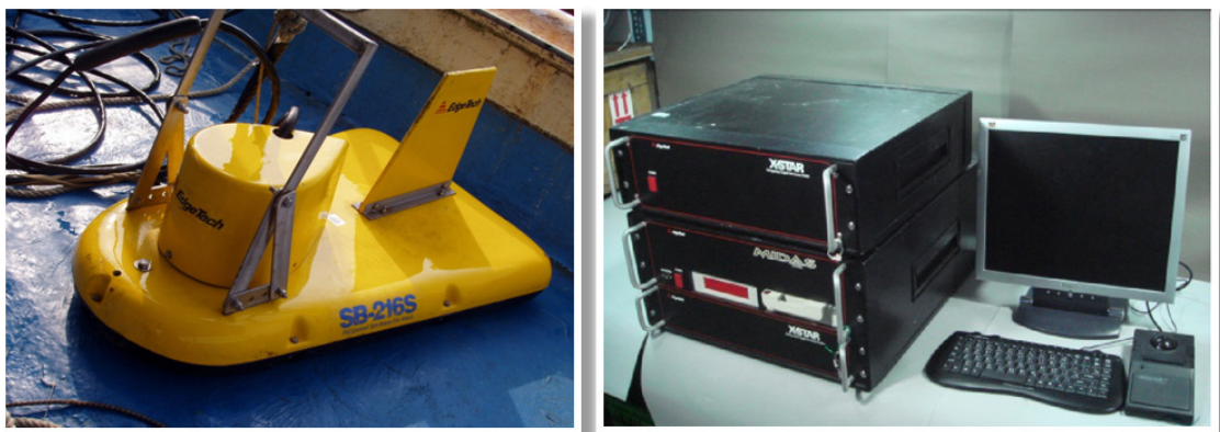
圖 2-28 EdgeTech SB-216S 拖魚(左圖)及 X-Star 資料收集處理系統(右圖)。
