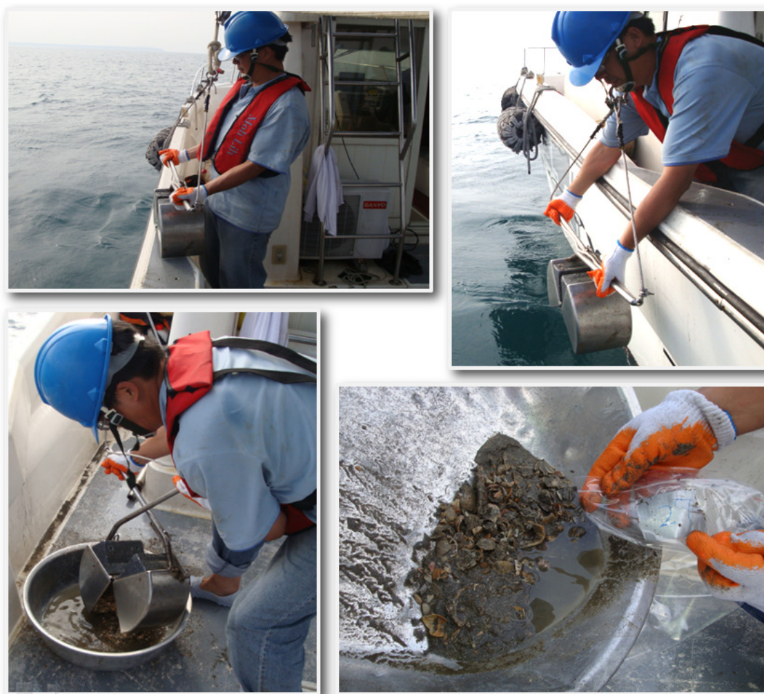
圖 2-23 當船行進到所設置的採樣點位置時，將採泥器用繩索綁好後，慢慢放入水中進行採樣，採樣完成後再將採泥器拉上來，將採泥器採得之樣本置放於大型容器內，並分放至標有該處採樣點編號的乾淨置物袋中。
