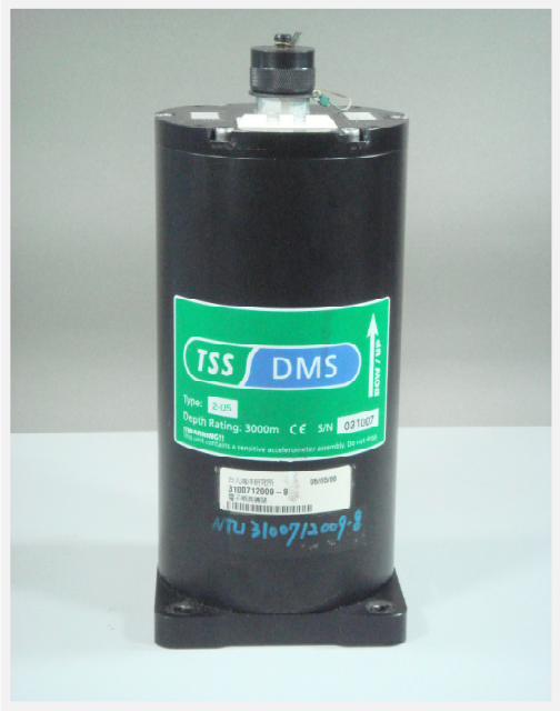
圖 2-8 TSS 公司所出產的 DMS2-05 型船體運動感測器。
