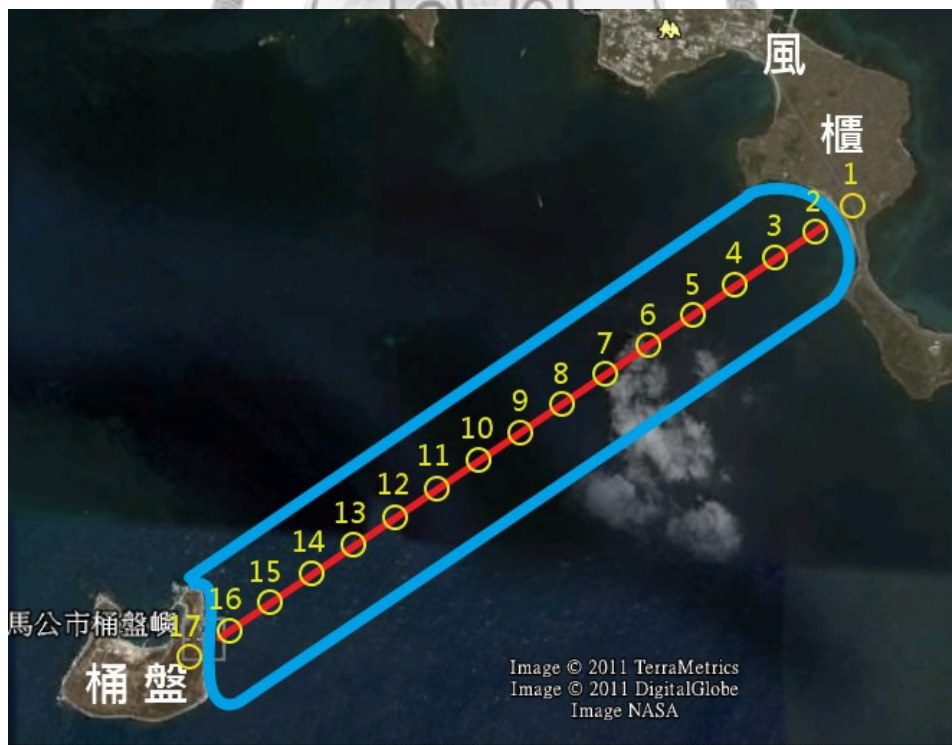
圖 2-24 風櫃至桶盤間海域之水下攝影路徑規劃圖。藍線框起之範圍為探測區域，探測區域內之紅線為拍攝路徑，黃色圓圈圈選處為採樣點，於採樣點處距離海床約 1~2 公尺之深度，進行海床生態拍攝。(底圖取自 Google Earth)
