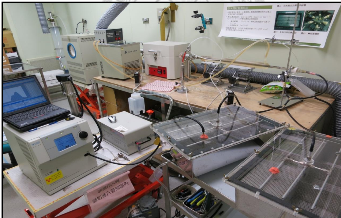
圖 1. 奈米微粒產生及全身暴露系統
