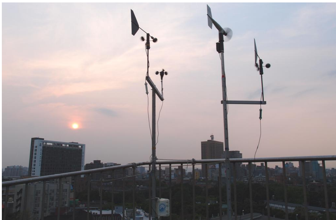
圖 2-5 各測站風速計擺放於同一處頂樓(國立臺灣大學大氣科學系 C 館)，進行同步觀測比對。
