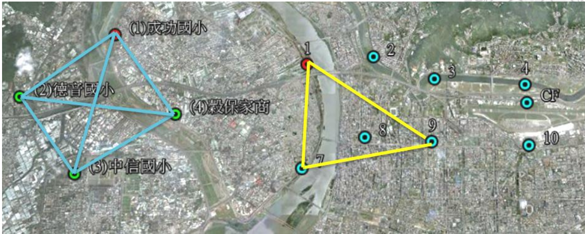
圖 3-17 松山機場 LLWAS 西側的 1、7、9 號測風臺圍成的三角形區域(黃色)，與臺北盆地西側氣象觀測網(藍色)，標記在 google 衛星影像圖上。
