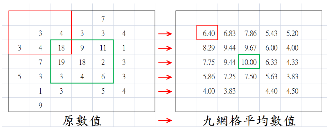
圖 5-2 「九網格平均數值」範例圖，左側為原數值，右側為九網格平均數值。黑色方框示意為圖 5-1 的紅色方框，最外圈邊界不計算九網格平均數值；原數值 9 格綠色方格平均的數值，呈現在九網格平均數值最中間的網格；原數值紅色方框遇到邊界無數值問題，9 格中僅有 5 格有數值，因此加總除以 5 成為九網格平均數值的左上角的網格。
