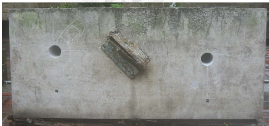
圖 5.9 模型試驗二敲擊點三與敲擊點四示意圖
