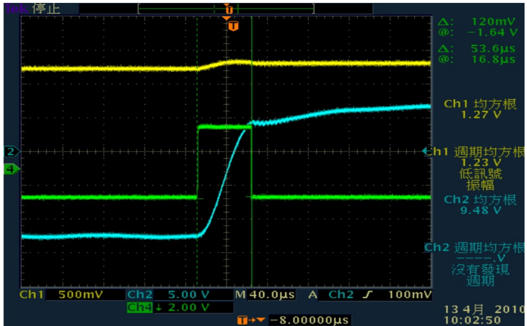
圖 4-7、壓電波形與控制功率開關之波形
