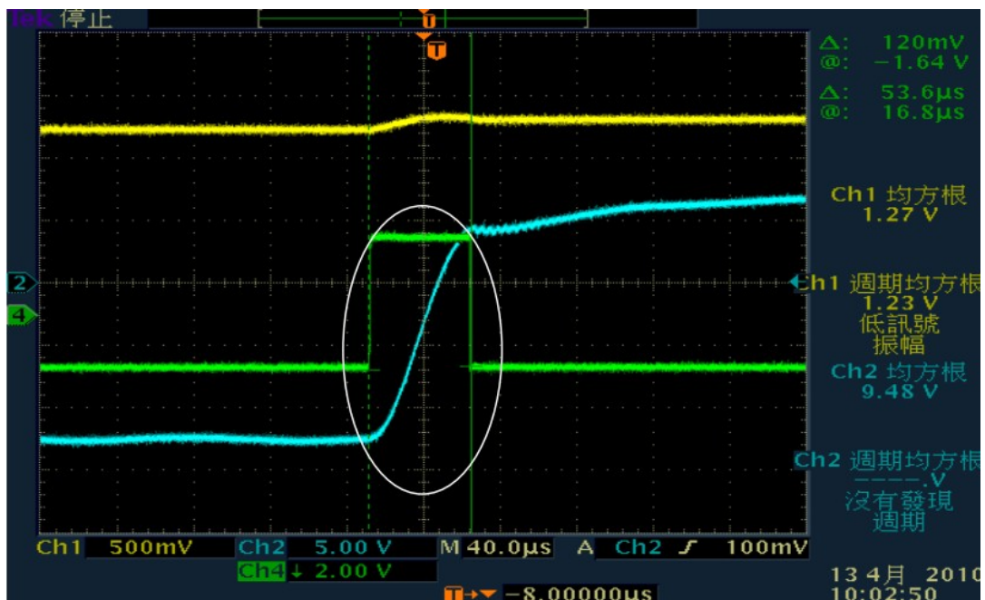
圖 4-19、壓電波形極性翻轉圖
